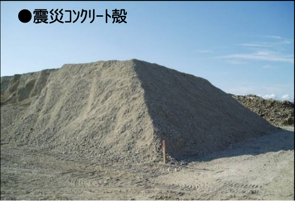
●津波堆積土砂、震災コンクリート殻、購入土を混合した土砂の活用実証試験状況
