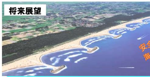
現在行っているヘッドランド整備、養浜工を上手に組み合わせることによって、豊かな砂浜の維持・回復を目指しています。
