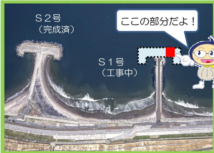
山元海岸では、海岸侵食が著しく砂浜の自然回復が見込まれないことからヘッドランド整備を進めております。人工的に岬に囲まれた地形を造り、流れを屈折させ波の力を弱める効果と流れる砂をためやすくする効果により海岸堤防及び砂浜を守る工事です。現在、ヘッドランドの先端に使用する16t型消波ブロックの製作工事を行っております。
