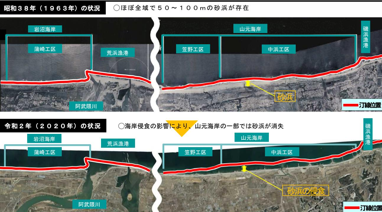
侵食が著しく自然の砂浜回復が見込まれない岩沼海岸（蒲崎工区）、山元海岸（中浜工区・笠野工区）においては、海岸堤防と一体となって効果を発揮するヘッドランド及び養浜の整備が必要です。
