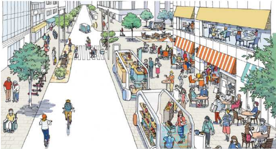
曜日や時間帯に応じて道路空間の使い方が変わる路側マネジメント
