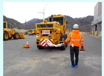
▲ロープで除雪機械とスタック車を結び準備完了！
