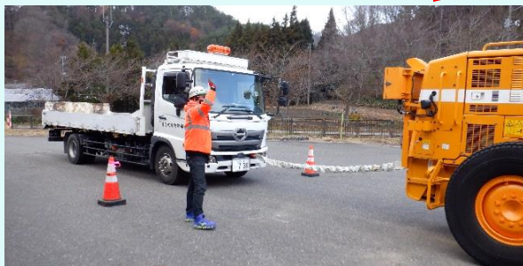
▲ゆっくりとスタック車を牽引します。実際の道路では駐車帯などにスタック車を引き上げます。
