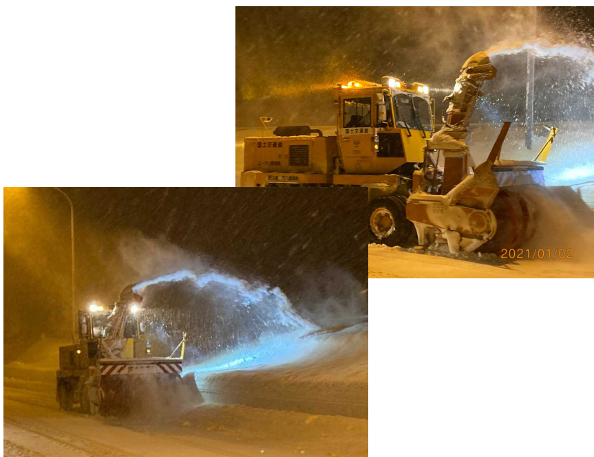
▲国交省ロータリー除雪車による除雪協力
