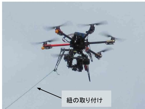
図 6. 4. 4 紐（ハーネス）を設置した UAV の例
