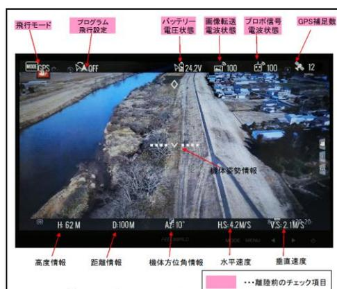
図 6.2.9 モニタによる機体情報
