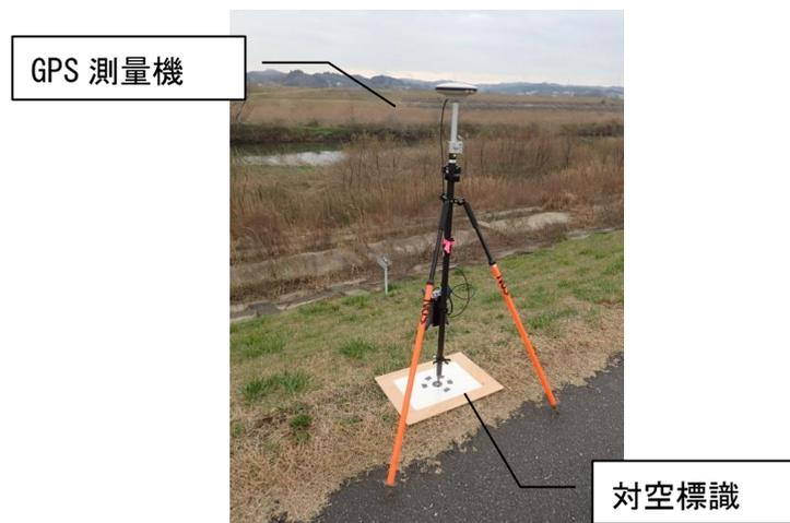
図 3. 3. 12 ターゲットの GPS 測量状況の例
