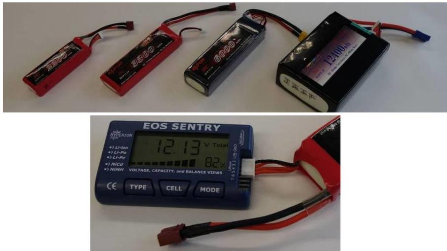
図 6.4.1 リポバッテリーの種類と電圧確認状況
