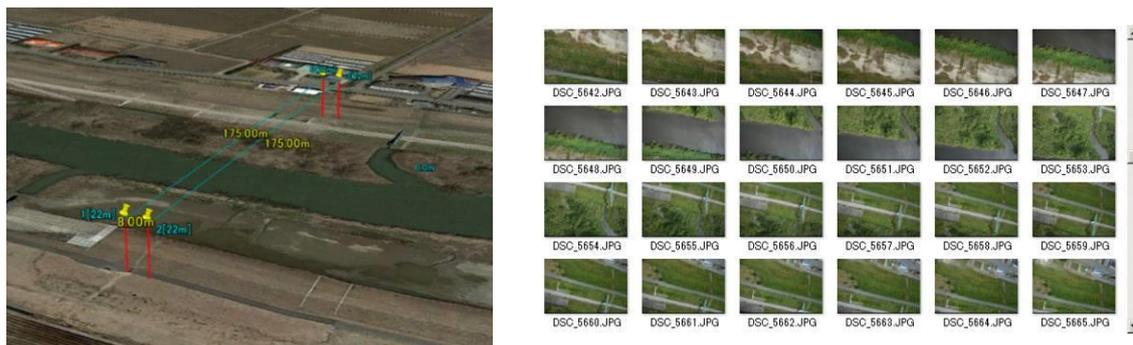
図 5.2.6 自動飛行経路設計と撮影した連続写真
