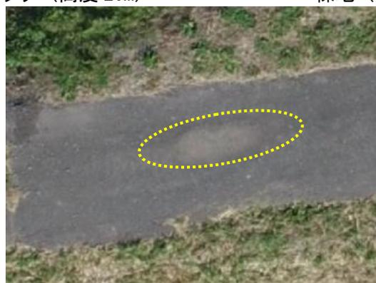
天端の沈下（水たまり跡）（高度 30m）
