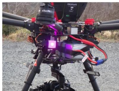
図 6.2.7 LED による状態確認の例
