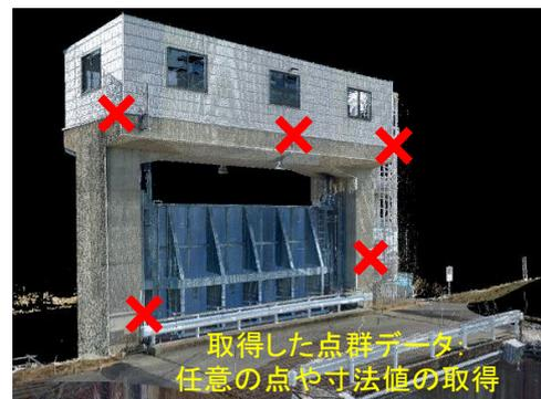
図 5.2.13 三次元レーザスキャナによる計測
