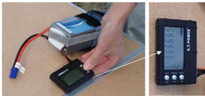
図 6.2.5 バッテリーの電圧およびセル圧確認状況
