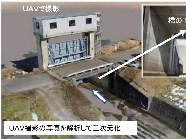
UAV撮影の写真を解析して三次元化
