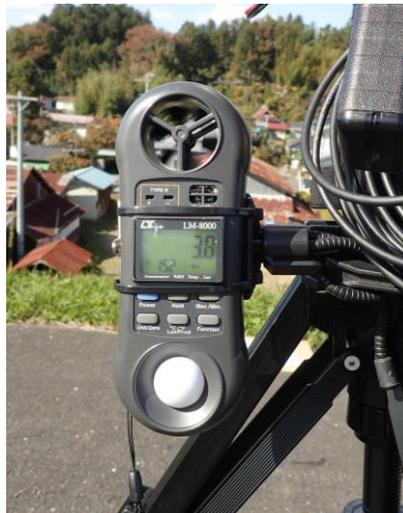
図 6.3.4 風速計の例
