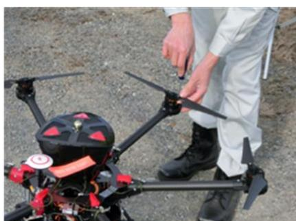
図 6.2.4 機体の点検状況
