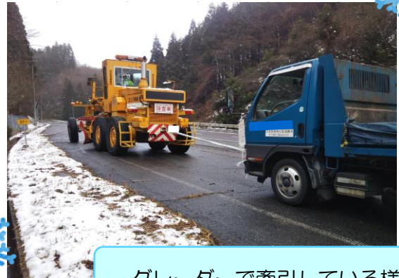
グレーダーで牽引している様子
