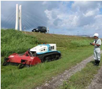
最上川中堤でリモコン式除草機の操作
