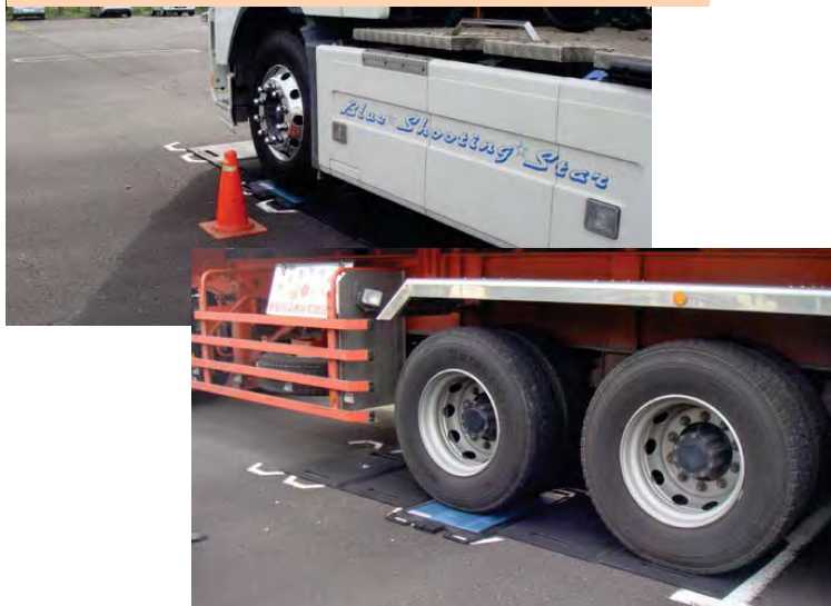
持ち運べる重量計でトレーラーの重さを車軸ごとに計る
