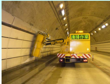
トンネル清掃時に活躍するのがこの「トンネル清掃車」です
