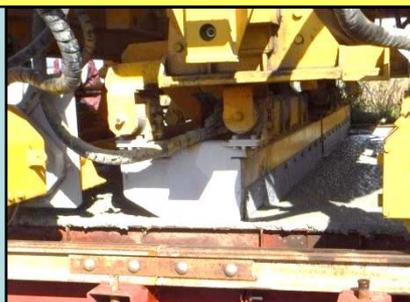
スプレッタによって生コンクリートを敷きならした後に、締固め、仕上げを行う機械です。
