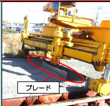
生コンクリートを敷き均す機械です。旋回横行自在のブレードで敷均します。
