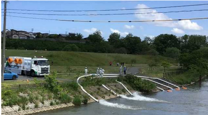
災害対策用排水ポンプ車による排水訓練
