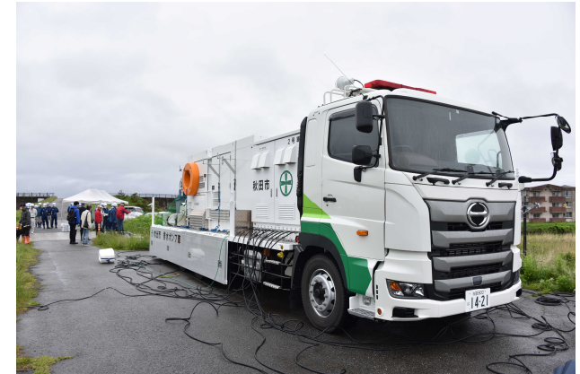
災害対策用排水ポンプ車（60m 3 /min）
