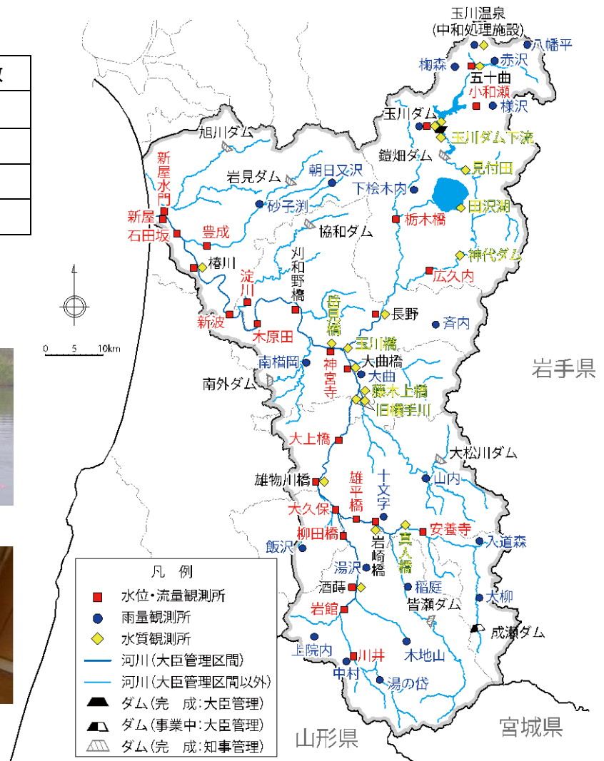
図 5-22 国土交通省（気象庁を除く）の水文観測地点（平成 26 年 3 月末時点）
