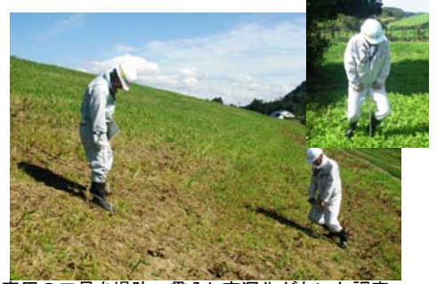
専用の工具を堤防へ貫入し空洞化がないか調査
