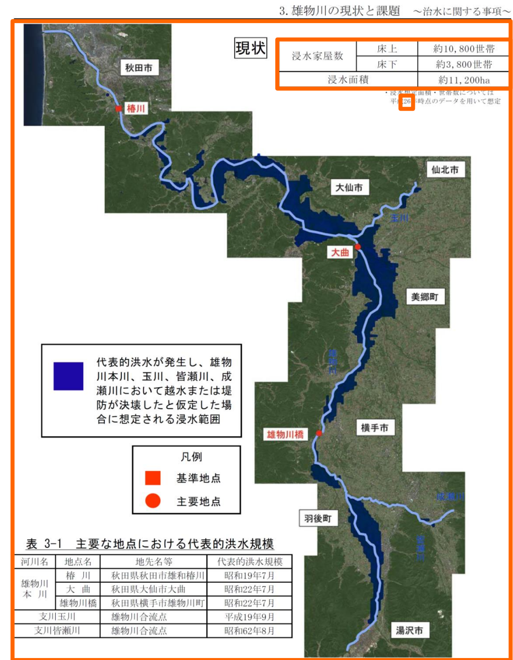
図 3-1 代表的洪水と同規模の洪水発生時の外水氾濫 ※ による浸水想定範囲
