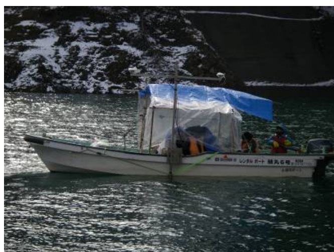
14 ダムの堆砂測量の様子
