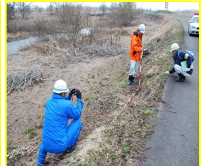
堤防の強度を測定している様子
