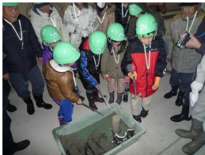
1時間後の普通コンクリートと超早強コンクリートの固まり具合を検証
