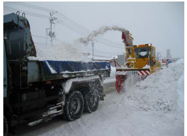
▲運搬排雪の状況
