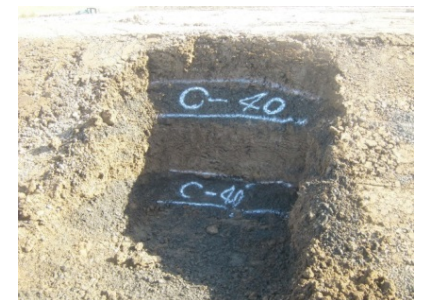
碎石投入後の仮置土
