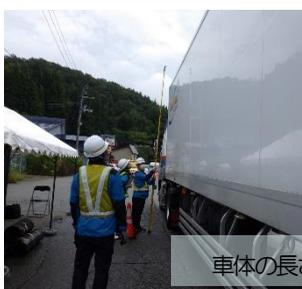
車体の長さ・幅・高さを測定
