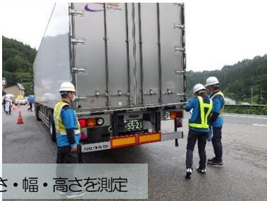
違法に重量を超過した車両は、道路や橋などの構造物に多大なダメージをあたえます。また、高さや幅を超過している車両が橋梁等に衝突する重大事故も発生しています。そのため、国土交通省では違法通行している大型車両の指導・取締りを行い、適正な道路利用を促進し、良好な道路環境の維持に努めています。
