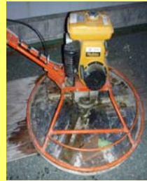
■トロウエル 床面に打設したコンクリートをならすために用いられる機械です。機械にコテが付いていて、回転させながらコンクリートを平らにします。
