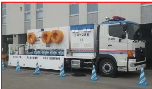
排水ポンプ車② (最大排水30m 3 /分)
