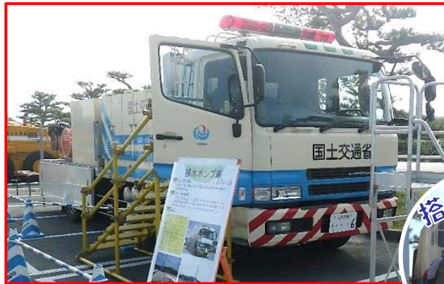
排水ポンプ車① (最大排水60m 3 /分) 30m 3 /分の排水ポンプを2個搭載しています。
