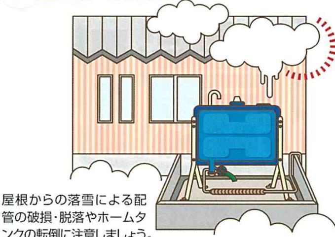
屋根からの落雪による配管の破損・脱落やホームタンクの転倒に注意しましょう。
