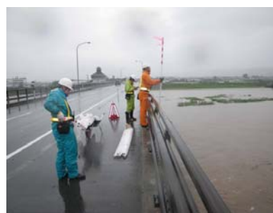
浮子観測の状況
