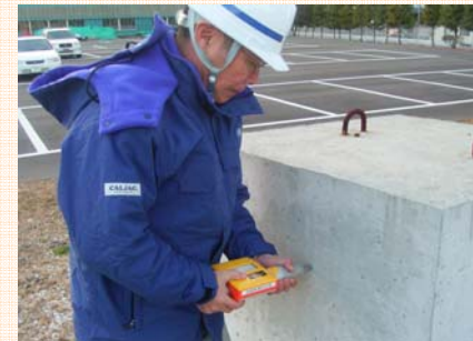
テストハンマーによる強度推定
