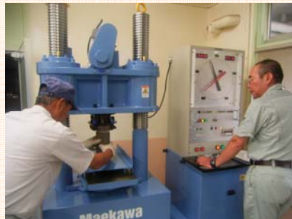
圧縮強度試験(実施)
