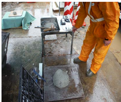
タッピングにより変形及び粘性の確認(ワーカビリティの判断)
