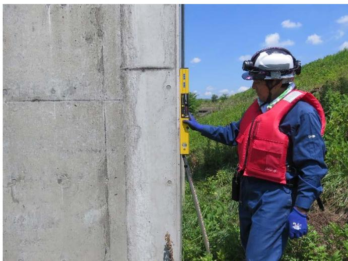
門柱の傾倒計測
