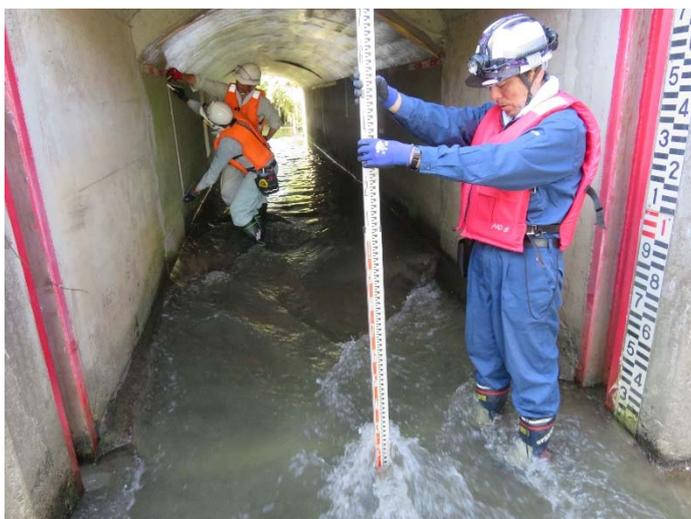
排水樋門内の沈下計測
