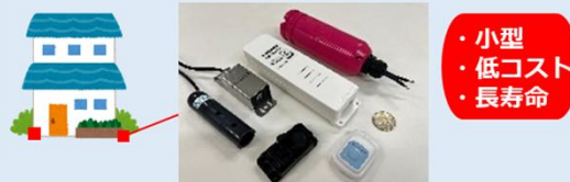
実証実験に用いている6種類の浸水センサ
