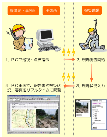
図 5-28 河川巡視点検システムのイメージ
