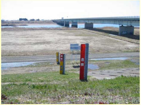
岩沼水位観測所危険標識設置
