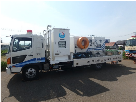
▲排水ポンプ車
