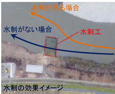
▲流れが河岸に寄ってしまい削られていくのを抑えるため、流れの方向を川の中心方向に変えます。
