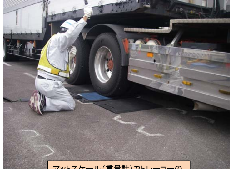
マットスケール(重量計)でトレーラーの重さを車軸ごとに計ります。
