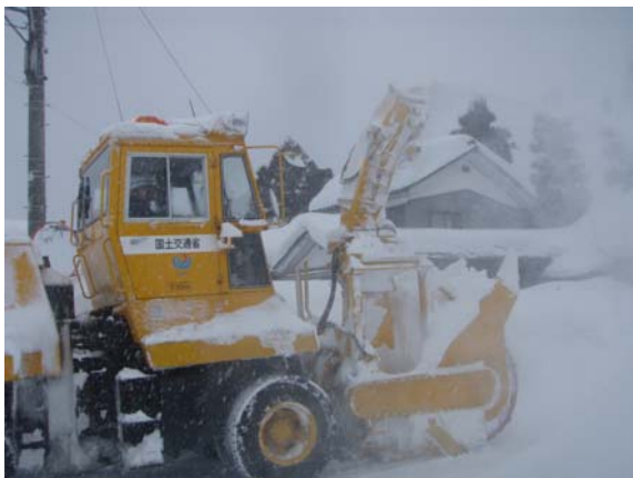
市町村道を除雪する国交省の除雪車(鶴岡市)
