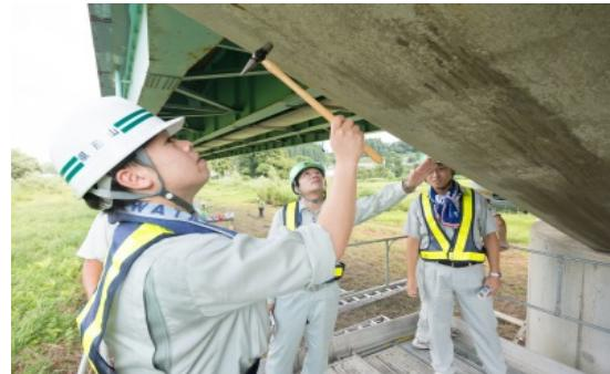
▲下部工の打音による点検状況
