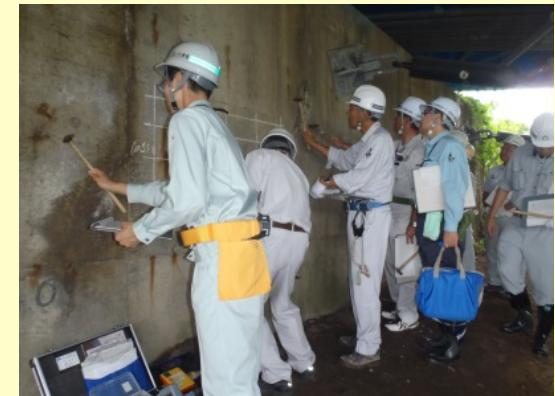
橋台（下部工）の打音診断状況
