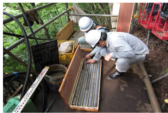
▲ ボーリングの確認
