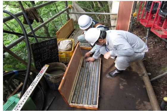
▲ ボーリングの確認
