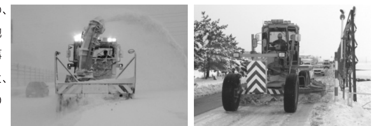
一般国道7号の除雪状況・凍結抑制剤散布状況
