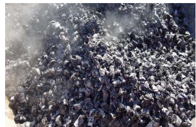
風弱く、気持ちの良い青空が広がる絶好の炭焼き日和。組み立て式の窯を設置します。長さ1mに切り揃えられた枝が1×4m分用意されていました(上)。火力の加減をみながら、どんどん焼いていきます(下)。
