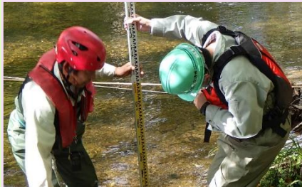
①断面積を算出するため水位を測ります。
