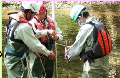
②流速計で2回測定を行い、平均値を記録係に報告します。
