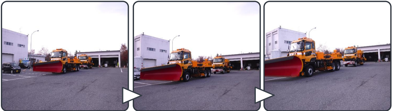
▲ 除雪車と立ち往生車両を牽引ロープで接続し、牽引する様子 ▲
