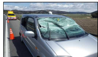
《落下物によるフロントガラスの損傷例》
