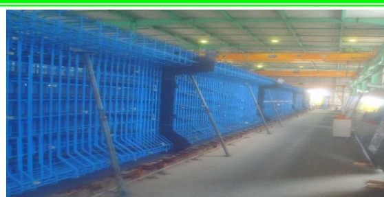
高耐久PC桁の工場製作状況
