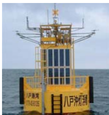
▲青森県沖の太平洋上に設置されたGPS波浪計
