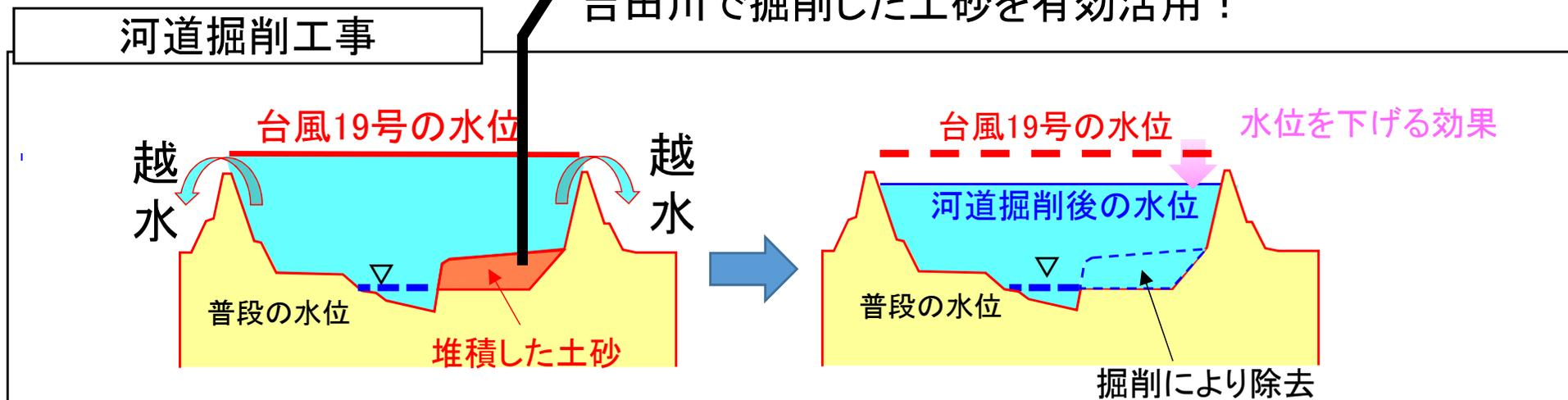
河道掘削工事は、川の中の土砂を撤去し、川の水を流れやすくする工事です。
